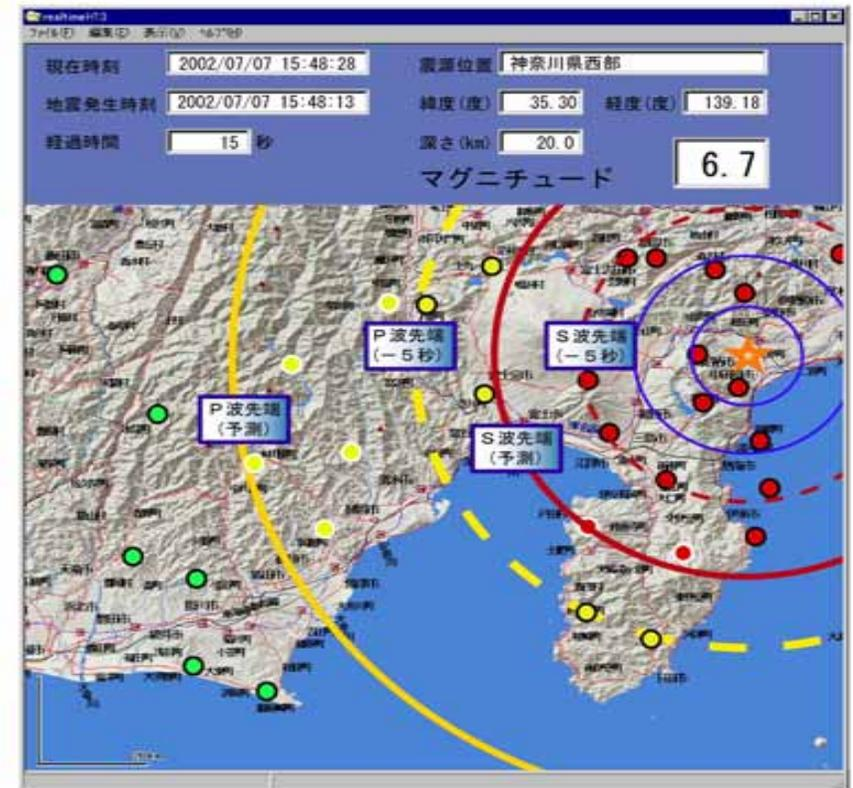
主要地震動(S波)到達前の緊急地震情報伝達により地震動被害の飛躍的軽減
