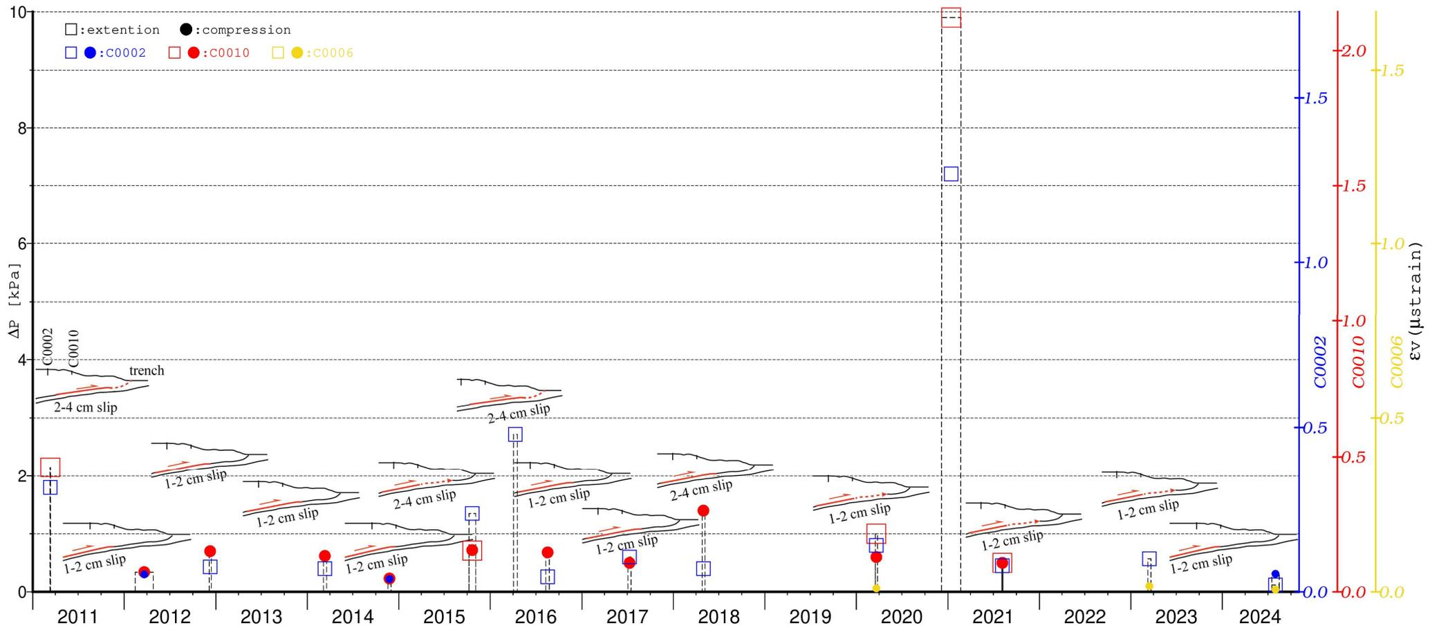
図7 孔内観測点において観測された SSE 発生時の間隙水圧変化 (Araki et al., 2017; Ariyoshi et al. 2021a を加筆・修正)。間隙水圧変化 ( $\Delta P$ ) とそれらを体積歪 ( $\epsilon_v$ ) に換算したスケールを縦軸に示している。●・□は、それぞれ圧縮・伸長方向の間隙水圧変化を示す。青・赤・黄のシンボルは、それぞれ C0002・C0010・C0006 (2020 年 3 月以降) の間隙水圧変化を示す。
