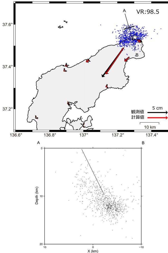
図 推定された震源断層モデル
