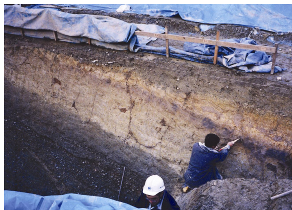
京都市が平成9年度に実施した三方・花折断層帯（京都盆地－奈良盆地断層帯）の西野山トレンチに現れた地層の傾斜（著者撮影）
