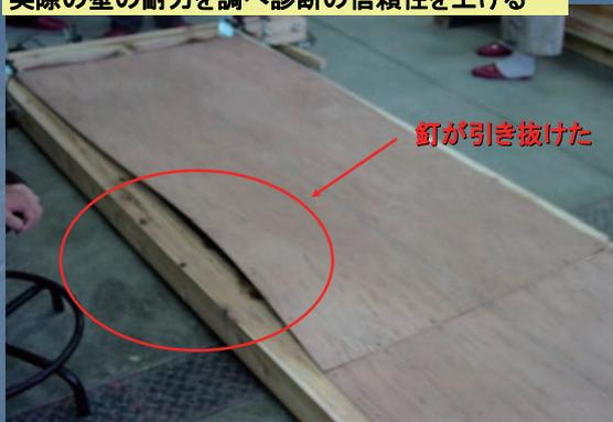
薄板ベニヤの耐力試験 釘止め接合部の破壊状況
