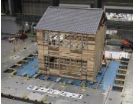
H22(兵庫県共同)：耐震補強技術が確立していない大規模な木造建物の診断・補強技術を提案。
