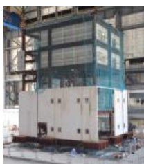
実験に用いた5層鉄骨試験体
