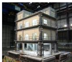
実験に用いた4層RC試験体
