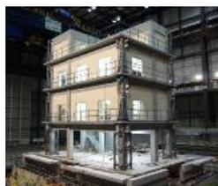
実験に用いた4層RC試験体
