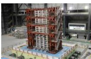
H24(建築基準整備促進事業)：長周期地震動に対する鉄筋コンクリート造建築物の安全性検証
