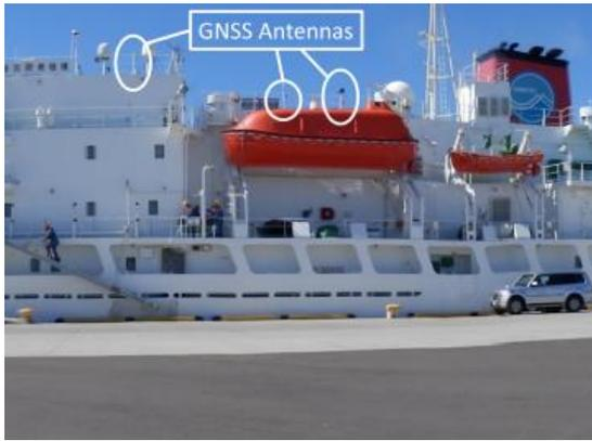
深海潜水調査船支援母船「よこすか」に装備された、GNSS・音響測距結合方式の海底地殻変動観測用のGNSSアンテナ
