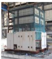
実験に用いた5層鉄骨試験体
