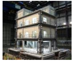
実験に用いた4層RC試験体
