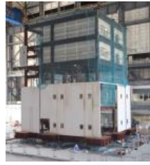
実験に用いた5層鉄骨試験体
