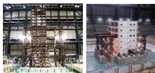
【共同研究】鉄骨造・RC造建物の崩壊挙動検証 (文部科学省「都市の脆弱性が引き起こす激甚災害の軽減化プロジェクト」)
