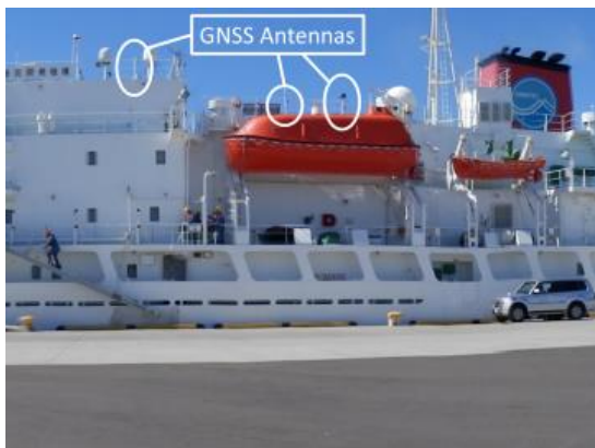
深海潜水調査船支援母船「よこすか」に装備された、GNSS・音響測距結合方式の海底地殻変動観測用のGNSSアンテナ 音響送受波器の船底装備も行い、GNSS/A観測を実施できる船舶の一つとなった。
