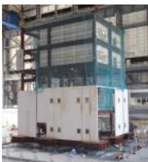
実験に用いた5層鉄骨試験体
