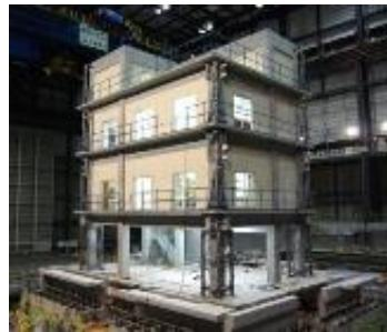
実験に用いた4層RC試験体
