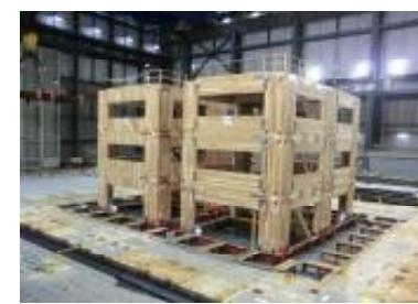
H26・27(国の設計基準へ貢献)：CLTを用いた建築物の一般設計法検証のためにデータを取得
