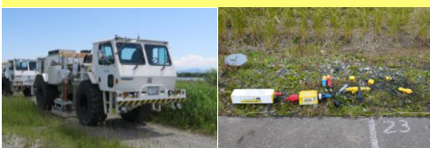
中・大型パイプレータ震源 独立型収録器の稠密・多数展開
