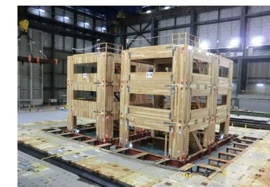
H26・27(国の設計基準へ貢献)：CLTを用いた建築物の一般設計法検証のためにデータを取得
