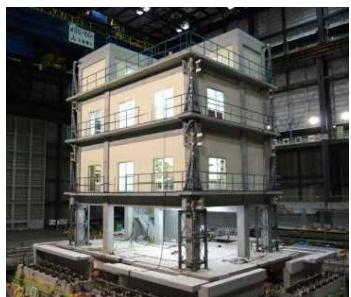
実験に用いた4層RC試験体
