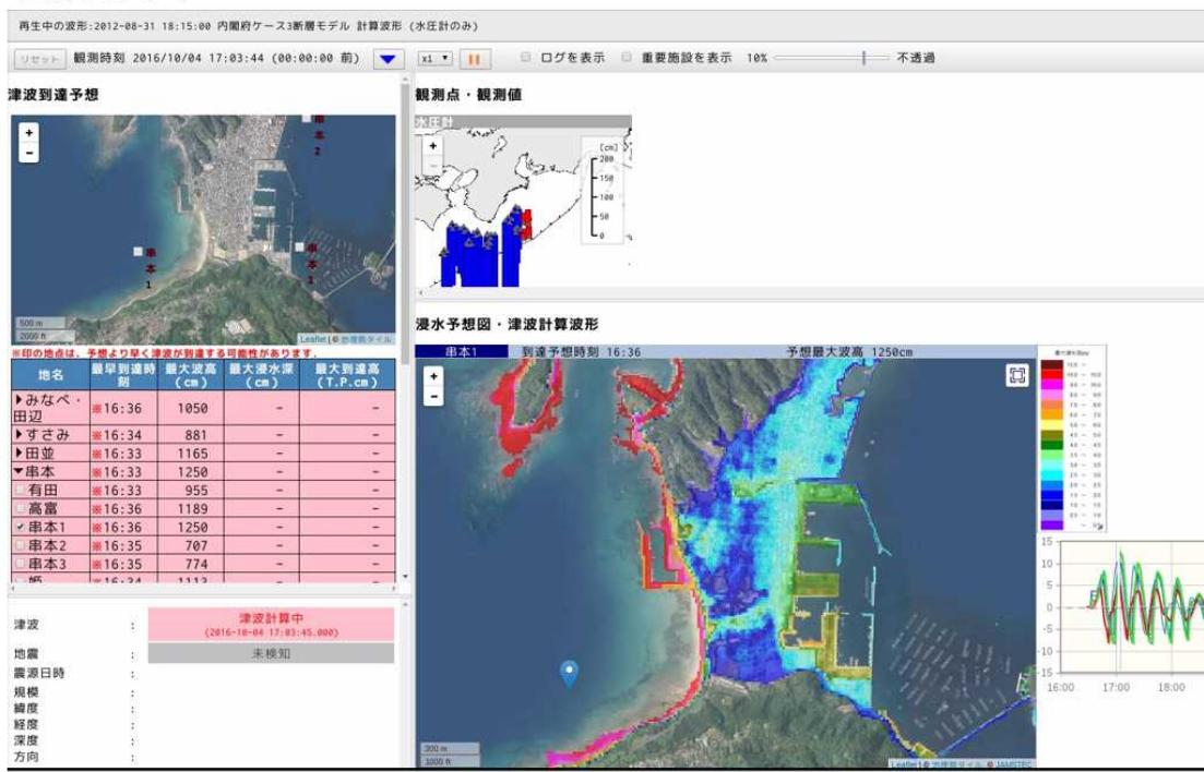
津波即時予測システムの和歌山県串本町の例。左上に全体地図、左下は各地域の津波到達時刻と津波高を表示、右上はDONETの水圧計データのリアルタイム表示、右下は浸水エリアとこの浸水マップ計算に使用した断層モデルによる串本町でも理論津波波形。
