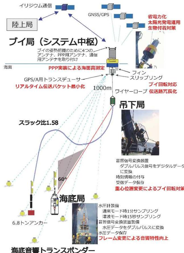
DONETのようなケーブルシステムが構築されていないエリアがまだ存在する。そのような場所において津波を検知し、即時予測につなげるために、ブイを用いた観測システムを開発した。これは、水圧計をとりつけた海底局を海底に設置し、海面に係留したブイまでデータを音響伝送し、衛星回線でブイから陸上局まで水圧データを伝送するシステムである。ブイにはGNSSが設置されており、海面高も10cm以下の精度で測定することが可能である。これにより、津波と地殻変動上下成分の分離もしやすくなる。現在、システムの高度化と検証を進めている。このシステムは機動性を持つ。DONETのようなケーブルシステムが設置されていない海域に、必要に応じて、必要なだけ設置することが可能である。
