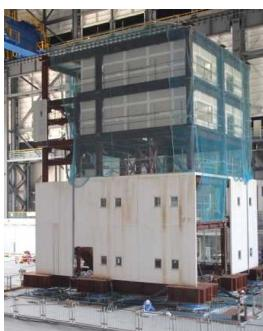
実験に用いた5層鉄骨試験体
