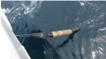
海底に設置作業中の地震計
