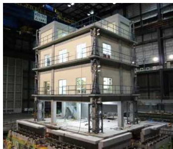
実験に用いた4層RC試験体
