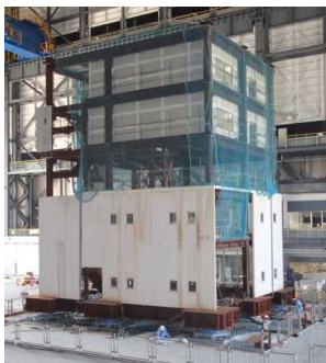
実験に用いた5層鉄骨試験体
