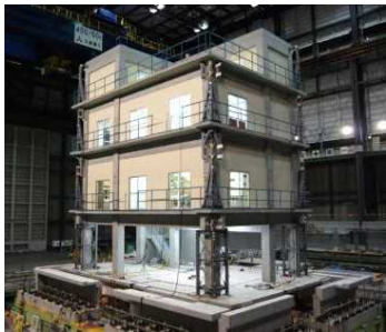
実験に用いた4層RC試験体
