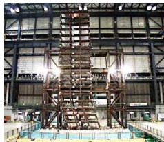
【共同研究】 鉄骨造・RC造建物の崩壊挙動検証 (文部科学省「都市の脆弱性が引き起こす 激甚災害の軽減化プロジェクト」)
