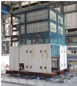
実験に用いた5層鉄骨試験体
