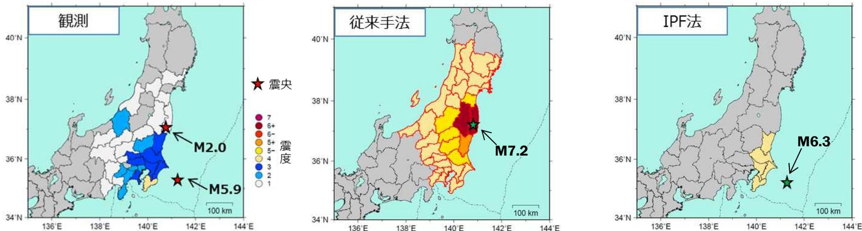
(左) 観測震度と実際に発生した地震の震源、(中) 実際に発表された、従来手法による推定震源及び警報発表区域、(右) 仮にIPF法を導入していた場合の推定震源及び予報発表区域。
