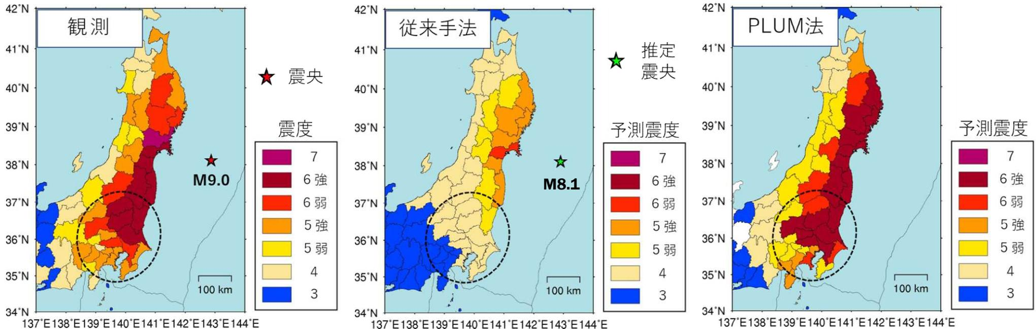
(左)観測震度と実際に発生した地震の震源。(中)実際に発表された、従来手法による推定震源及び予測震度(右)仮にPLUM法を導入していた場合の予測震度。従来手法は震源域の広がりに対応できなかったため、関東地方の強い揺れが予測できなかった(図中黒円内)。PLUM法は揺れの広がりそのものから揺れを予測するため、震源から離れた関東地方の強い揺れも予測できる。
