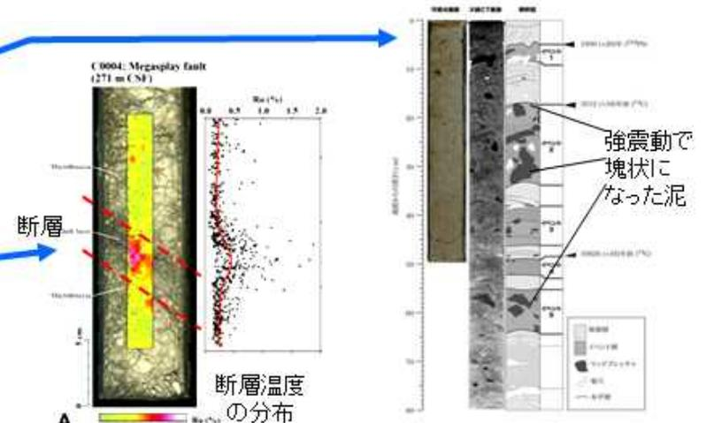
プレート境界浅部での高速滑りを示す地質試料(津波規模の推定)
