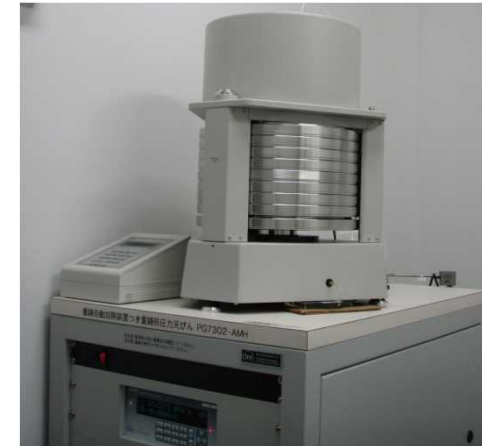
JAMSTECの運用する圧力基準（重錘天秤）
