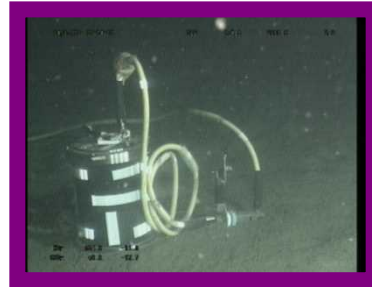
円筒容器 海底での広帯域地震計の設置状況
