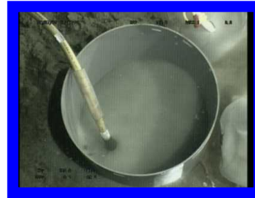
円筒容器 海底での広帯域地震計の設置状況
