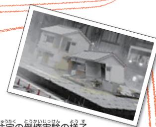
木造住宅の倒壊実験の様子
