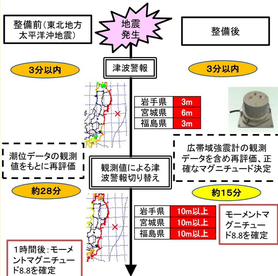
巨大地震発生時においても振り切れることなく観測可能な広帯域強震計による解析を行うことにより、地震の規模を早期に把握(15分程度)し、津波が沿岸部に到達する前に適切な津波警報を発表可能。
