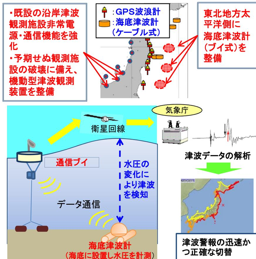
沿岸から沖合までの津波監視体制を強化することにより、第2波、第3波を含め、より迅速かつ正確な津波の高さの予測が可能。
