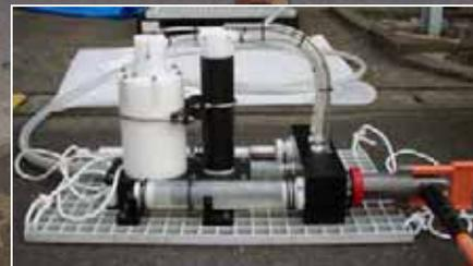
圧力センサシステム (津波計)
