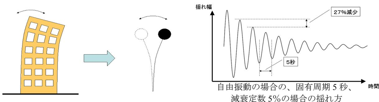
\*長さのあるものを一つのおもりの動きに代表させて表す（左図）ため、例えば、一般的な超高層建物の頂部の応答は、応答スペクトルの値の 20～30%程度増しになることが知られている。
