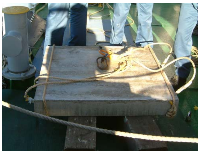
図 2.3.5-2 海底ベンチマークとして用いたコンクリート製の平板
