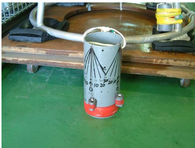
図 2.3.5-4 船上で急遽作成した簡易傾斜計
