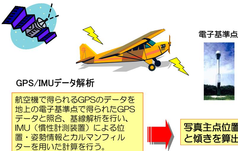
図 2.3.2-5 POS/IMU の説明図
