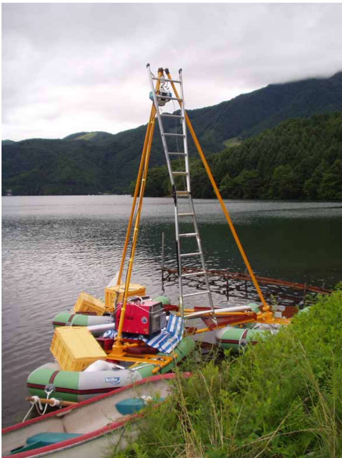
図 2.3.3-4 ピストンコア採取筏（いかだ） 青木湖にて撮影
