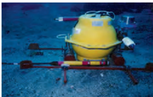
自己浮上式海底地震計を用いた観測の様子 (国立研究開発法人 海洋研究開発機構提供)
