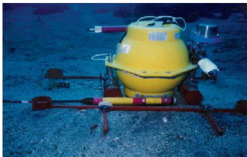
自己浮上式海底地震計を用いた観測の様子
