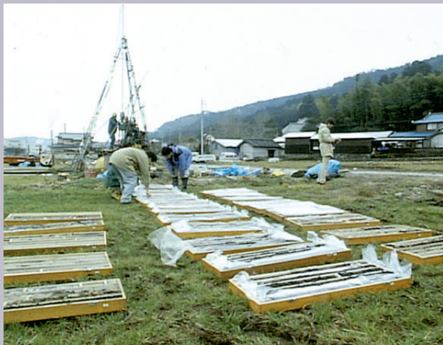
ボーリング現場でコアを調べている例(富士川河口断層帯)
