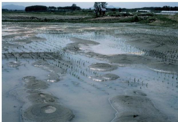
図2-28 「昭和58年(1983年)日本海中部地震」による噴砂の跡(秋田県若美町(旧名、現在の男鹿市))
