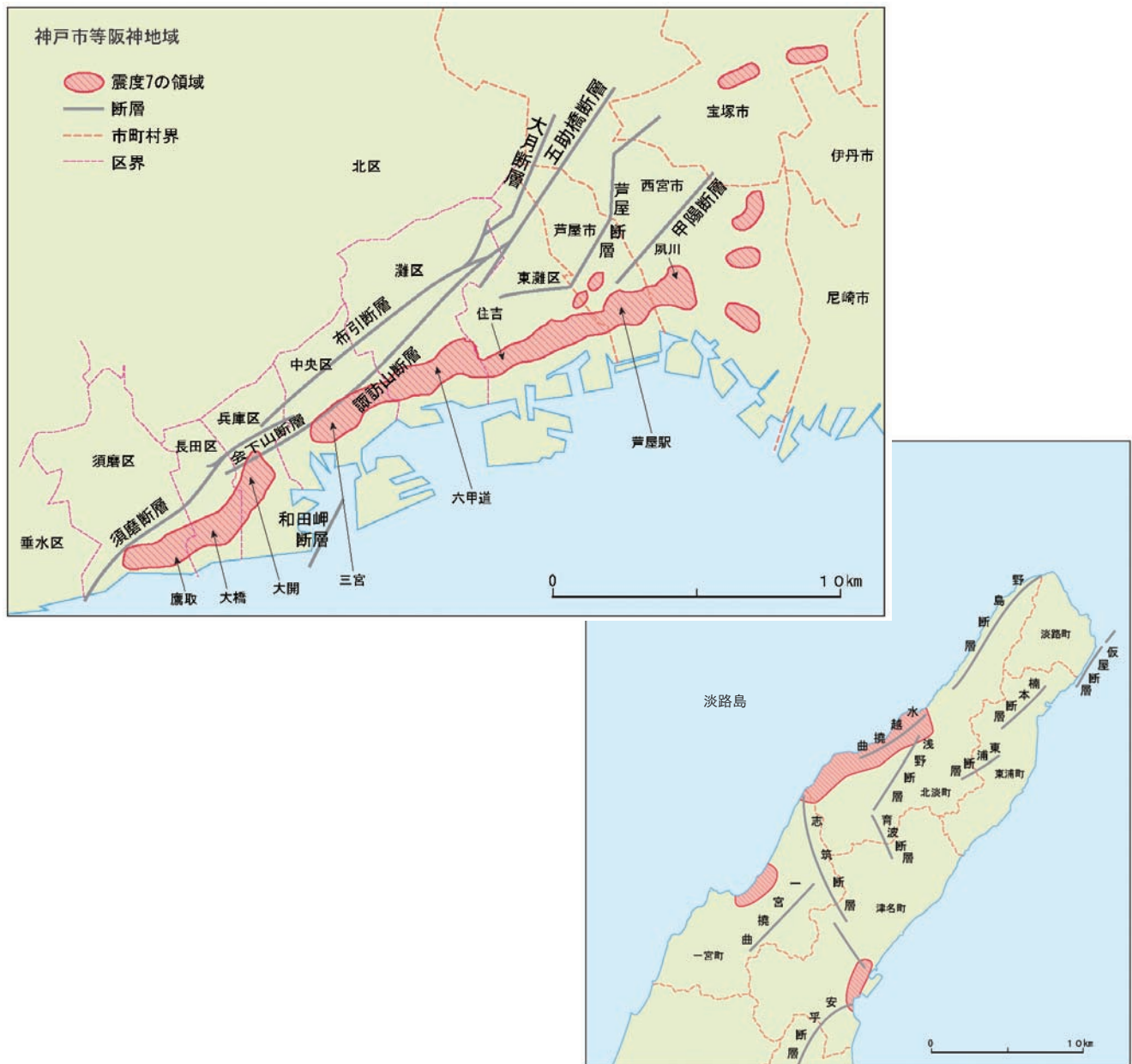
図7-19 「平成7年(1995年)兵庫県南部地震」の震度7の分布(現地調査による) [吉川・伊藤(1995)などから作成]
