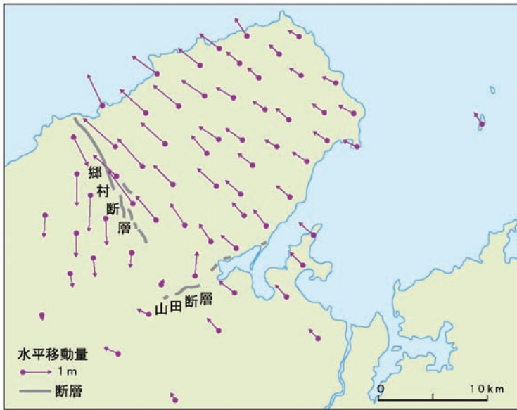
図7-8 北丹後地震による三角点の水平移動量 [Tsuboi (1930)から作成]
