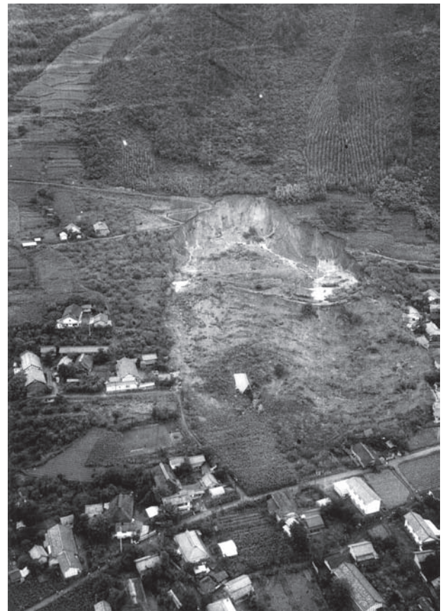
図6-26 「松代群発地震」により発生した地すべり(松代町牧内地区) [信濃毎日新聞社提供]
