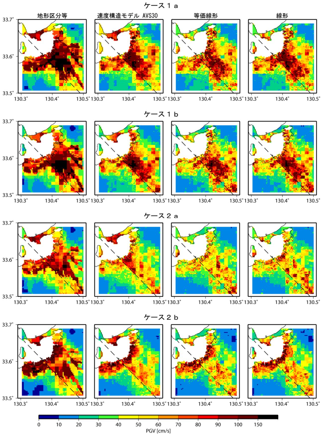
図 20 各種手法による地表の最大速度分布
