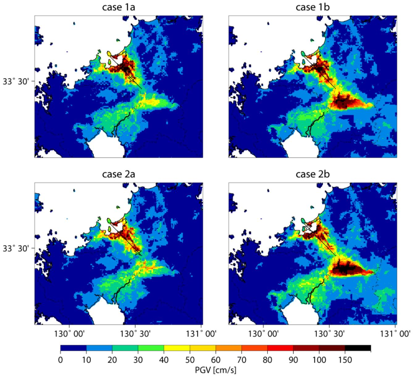
図 18 最大速度増幅率（図 5）を用いて求められた地表の最大速度分布
