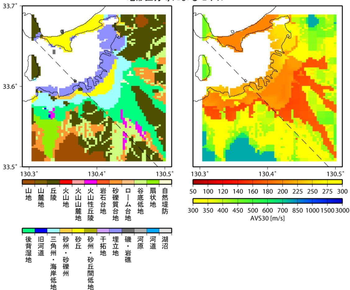
図 24 浅い地盤の速度構造モデル（上）と地形区分等による地盤モデル（下）
