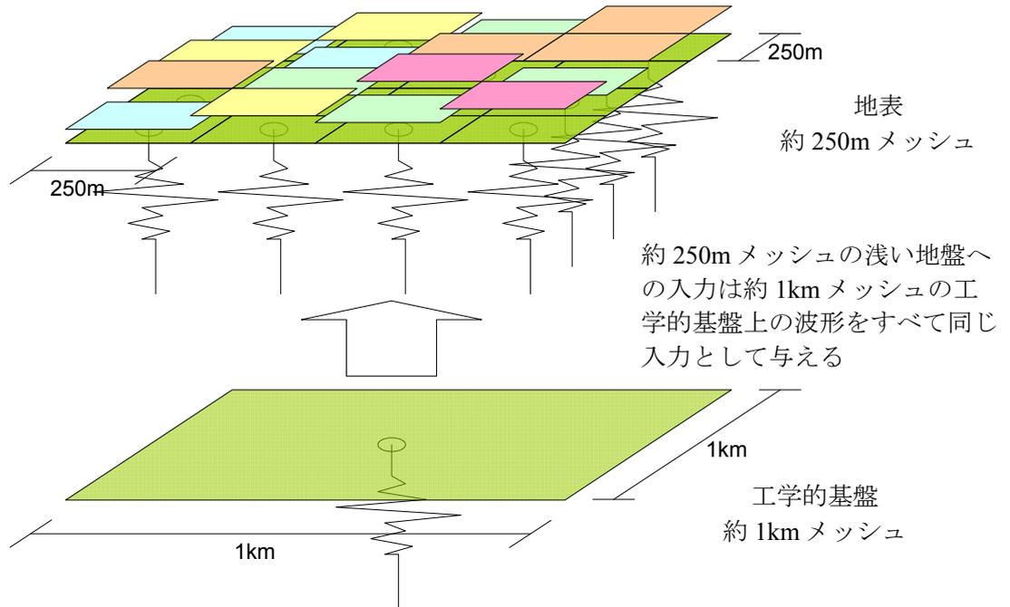
図 6 約 1km メッシュの工学的基盤での波形の約 250m メッシュの表層地盤への展開イメージ
