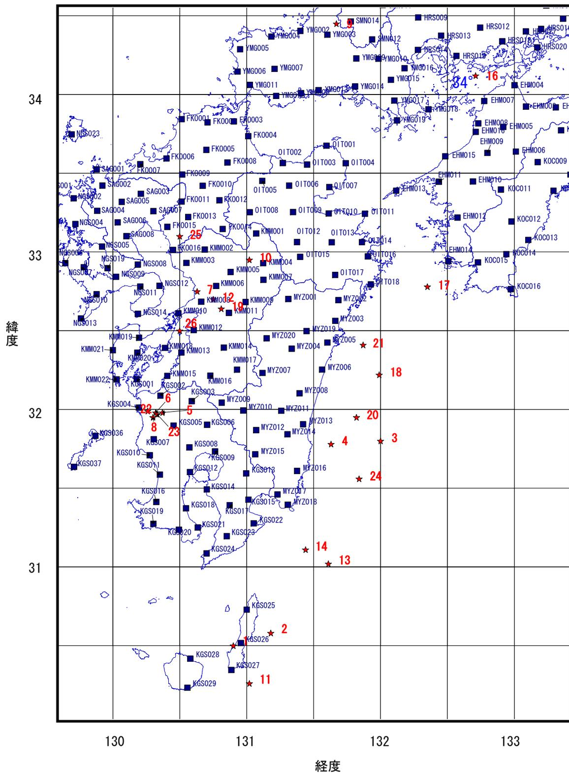
図 17 収集した地震記録の震央位置、K-NET の観測点、及び収集地震観測記録リスト
