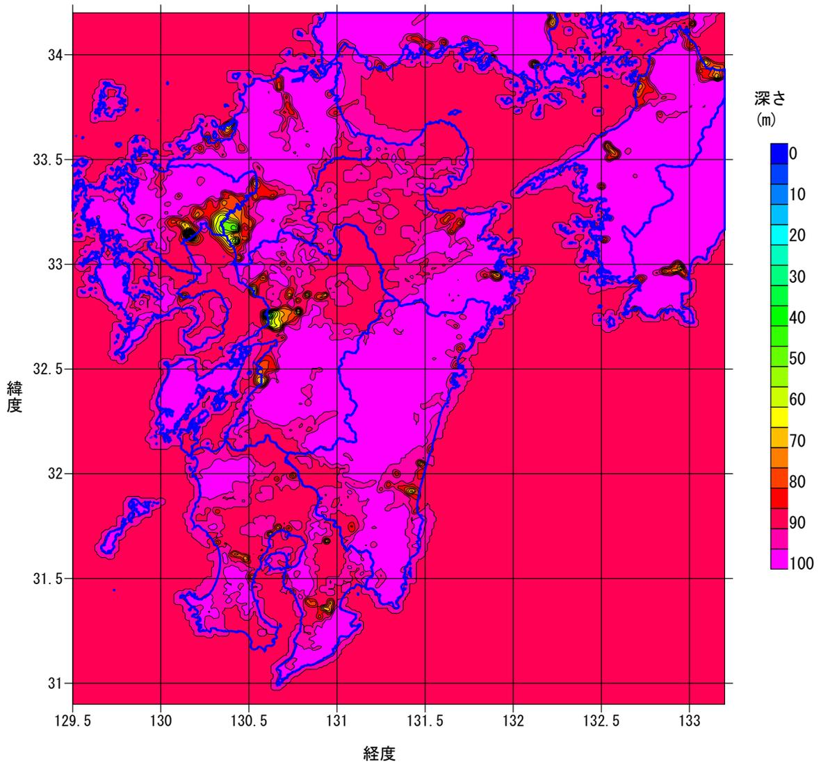
図 4 - 3 詳細法工学的基盤 ( $V_s=500\text{m/s}$  層上面) の深さ分布図
