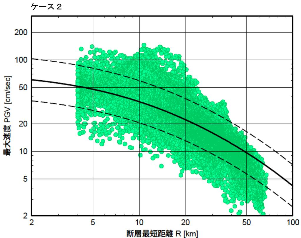
● 詳細法による工学的基盤上面の速度最大値 ( $V_s = 600 \text{ m/s}$  へ補正)
