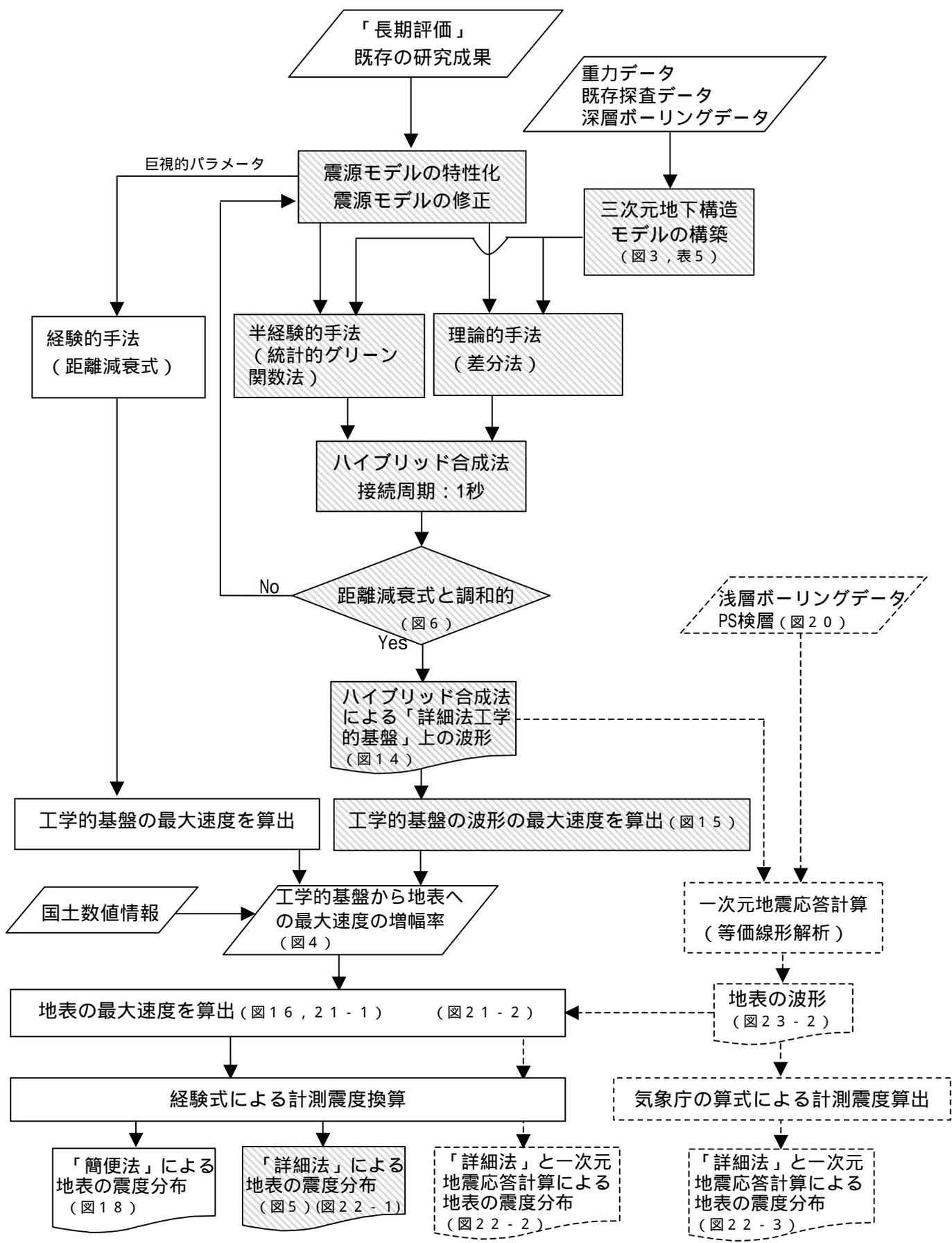
図7 強震動評価の流れ
