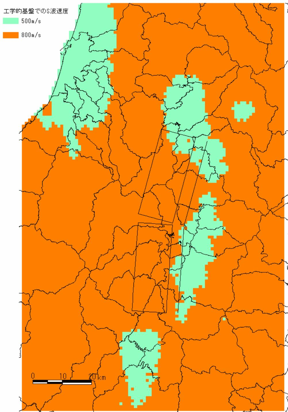
図14 「詳細法工学的基盤」上におけるS波速度
