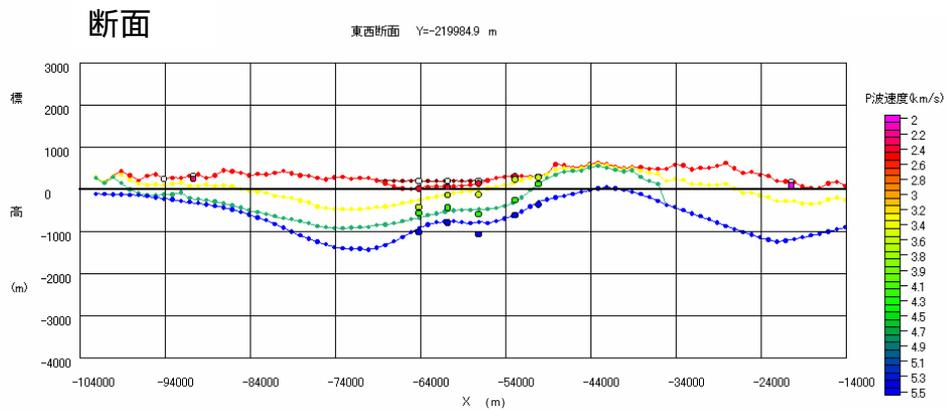
断面内の丸は弾性波および Hi-net の実測 P 波速度をプロットしている。
