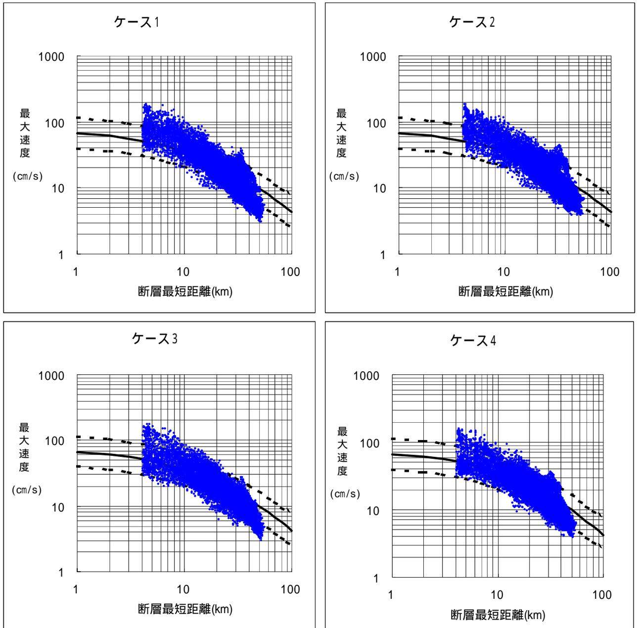
図6 「詳細法工学的基盤」における最大速度を  $V_s=600\text{m/s}$  相当に換算補正した値と 司・翠川(1999)の距離減衰式 ( $M_w=7.1$ ) との比較
