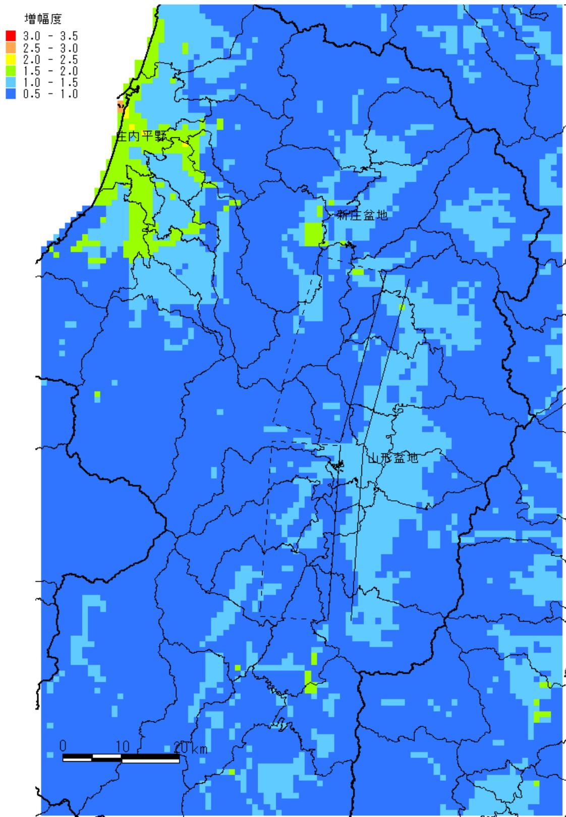
図4 工学的基盤 ( $V_s=400\text{m/s}$  相当) から地表までの最大速度の増幅率 (浅い地盤構造)
