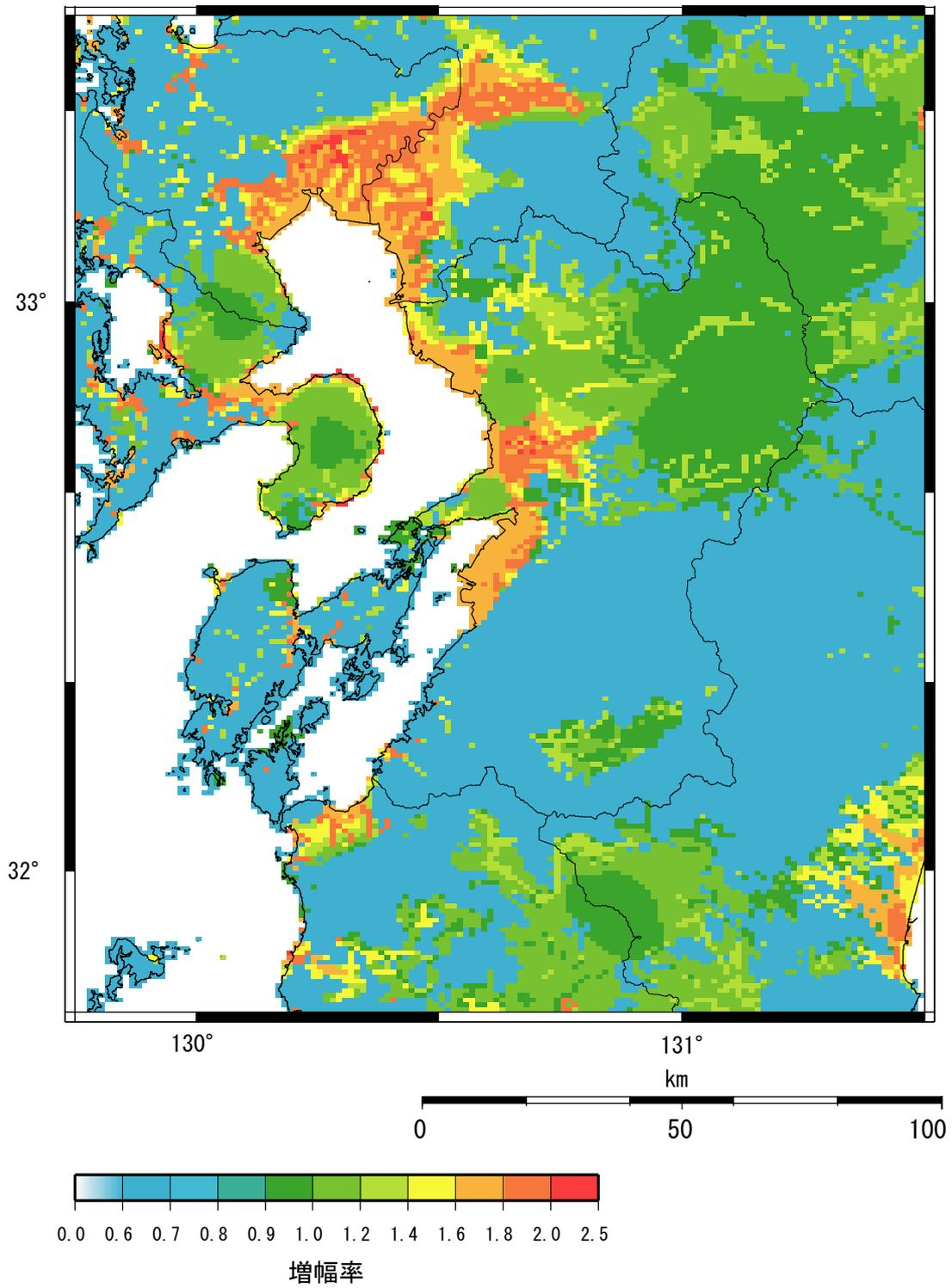
図4 工学的基盤 ( $V_s=400\text{m/s}$ 相当) から地表までの最大速度の増幅率 (浅い地盤構造)
