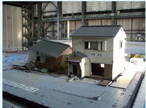
耐震補強の有無による木造家屋の震動破壊実験の様子
