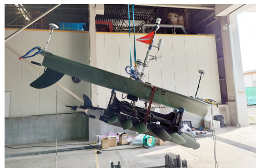
海底地殻変動観測用ウェーブグライダー
