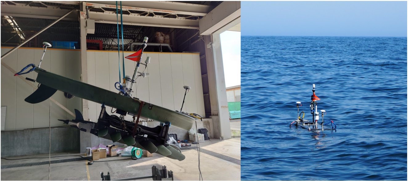
図2 海底地殻変動観測用ウェーブグライダー。フロート部中央部に気象センサーやLEDライト、衛星通信用アンテナ等、前後にGNSSアンテナ、また、後方底部に音響トランスデューサーがそれぞれ搭載されている。左の写真でフロート部の下に台座を挟んで吊られているグライダー部は、海域投入後（右写真）では海面下8mを潜航している。
