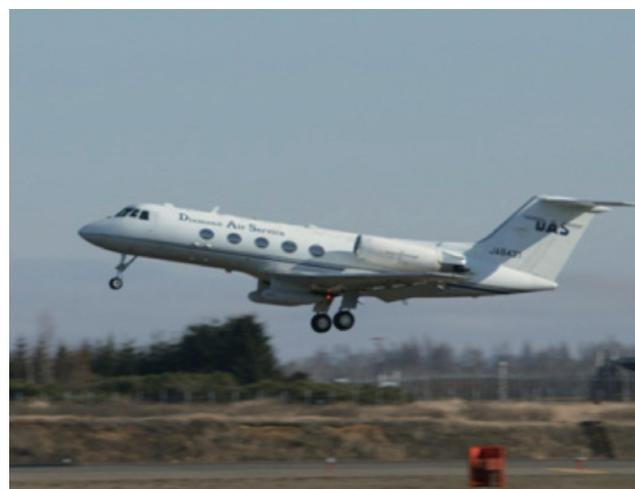
図2 Pi-SAR2を搭載した航空機(ガルフストリームII)。翼下の2つのポッドの中にアンテナを収容。2つのアンテナで取得するデータの位相差は視差に起因することから、表面の起伏(高さ)を計測できる。
