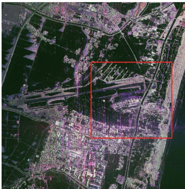
図1 Pi-SAR2で観測した東日本大震災翌日の仙台空港周辺。5km×5kmの領域。ポラリメトリ機能を用いてカラー化している。赤枠は図4の領域。
