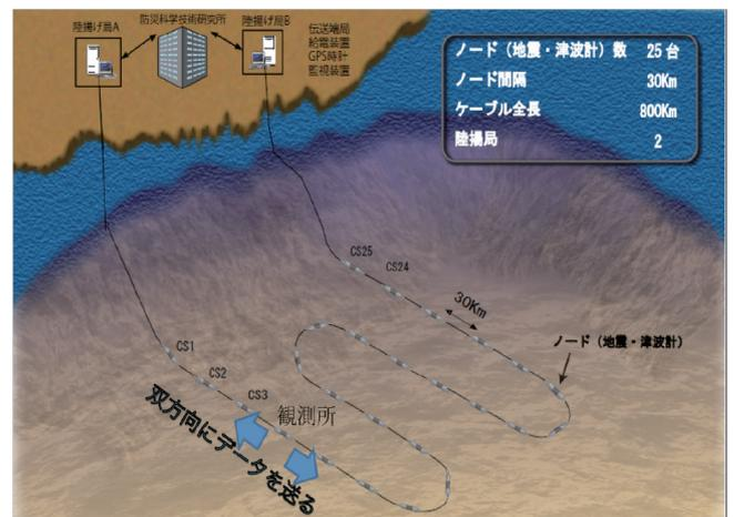
図2. 各海域に設置する海底地震津波観測システム
