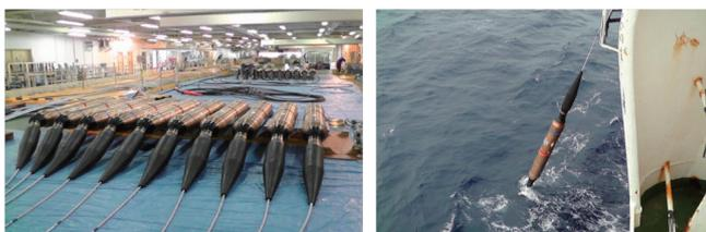
図5. 房総沖システムと海中投入直前の地震津波計
