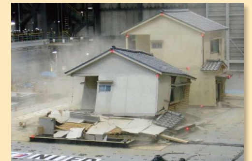
■木造住宅の耐震補強効果の検証実験
