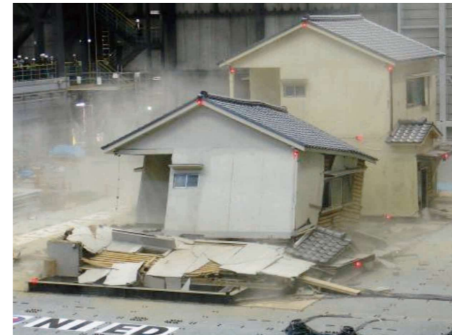
図3 木造住宅の耐震補強効果の検証実験 ※築30年の木造住宅を移築し兵庫県南部地震の観測波で加震、手前は無補強の住宅、奥は耐震補強した住宅。
