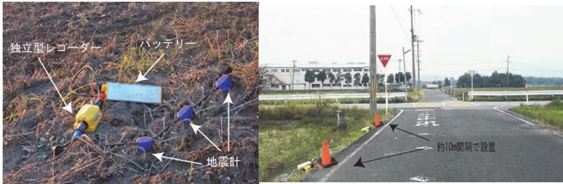
図9 地震計設置例
