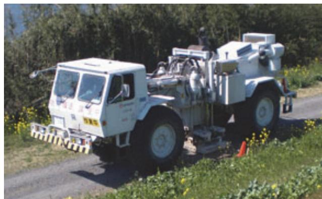
図 8 大型バイブレーターの外形
